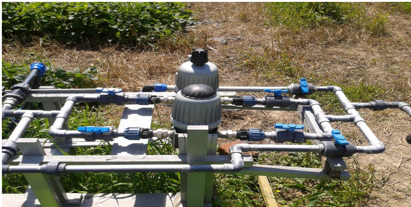
Рисунок 31 - Растворный узел для капельного полива и фертигации в полевых опытах
